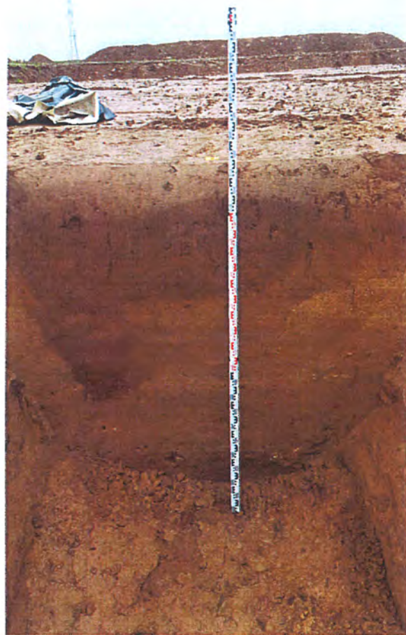
Bild 1: Schurf 1 (Sch 1) bis in eine Tiefe von 2,3 m unter GOK
