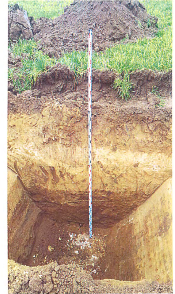
Bild 4: Schurf 4 (Sch 4) bis in eine Tiefe von 3,3 m unter GOK; anstehender Kalk in der Sohle des Schurfs
