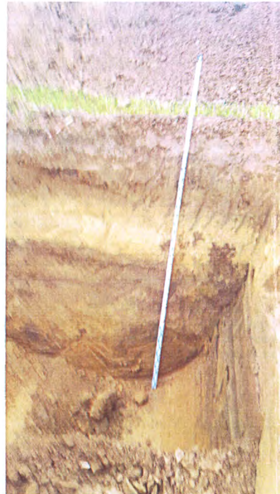
Bild 2: Schurf 2 (Sch 2) bis in eine Tiefe von 3,4 m unter GOK
