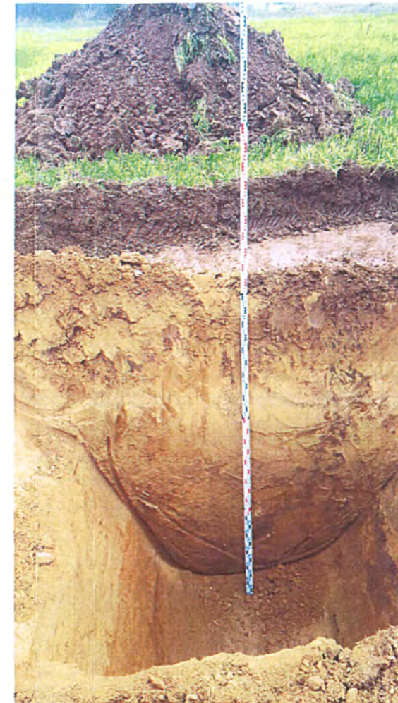
Bild 3: Schurf 3 (Sch 3) bis in eine Tiefe von 3,3 m unter GOK
